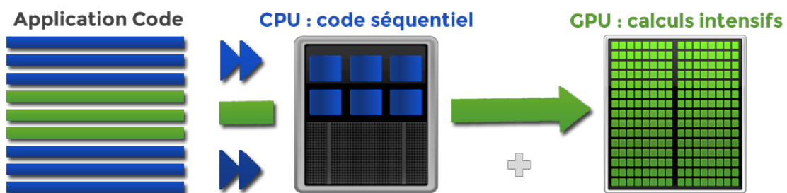
FIG. 8.4 – Principe de l'approche hybride
